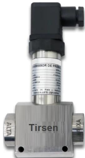
Os Transmissores Diferenciais TSTP.400D têm elemento sensor piezoresistivo que converte a diferença da pressão entre o lado de alta pressão e o lado de baixa pressão aplicada pelo fluido em sinal elétrico, este sinal elétrico é amplificado, linearizado e disponibilizado em sinal padronizado por uma eletrônica de alta confiabilidade construída com componentes em SMD. São disponíveis versões para aplicação nos ambientes industriais e de pesquisa.
