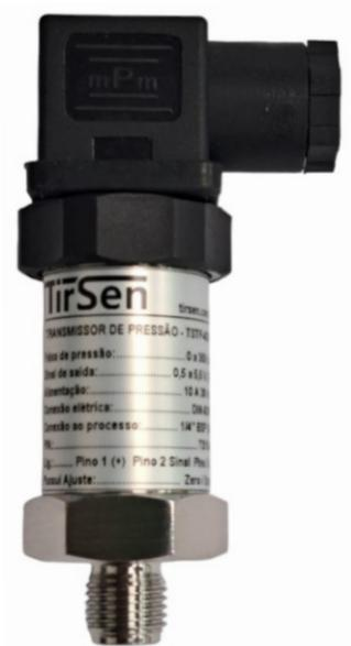
O TSTP.400 é um transmissor de alta performance, seu sensor é totalmente em aço inox AISI 316/304. Compatível com grande parte dos fluidos industriais em processos pneumáticos, hidráulicos, gases corrosivos. A eletrônica microcontrolada, garante precisão e durabilidade aliada a um sensor Piezorresistivo, onde as técnicas de fabricação são as mais atuais.
